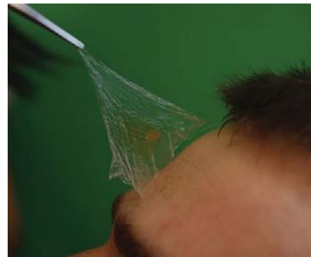
Obr. č. 11 Epidurálny elektronický systém EES (e-tetovanie) 4
