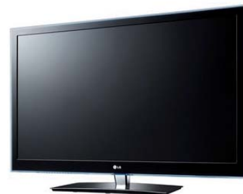
Obr. 9 3D monitor s technológiou využitia pasívnych okuliarov 6
