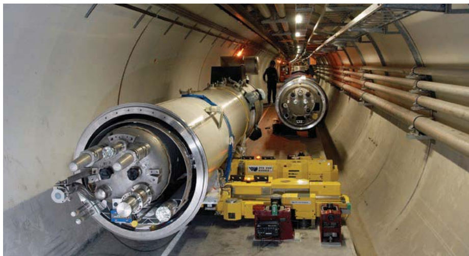
Oživovanie systému pohonov na polohovanie tripletu kryomagnetov v CERN-e
