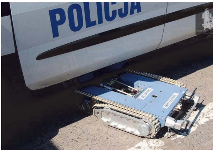
Pyrotechnický minirobot SCORPIO s vodným delom na likvidáciu nástražných výbušných systémov
