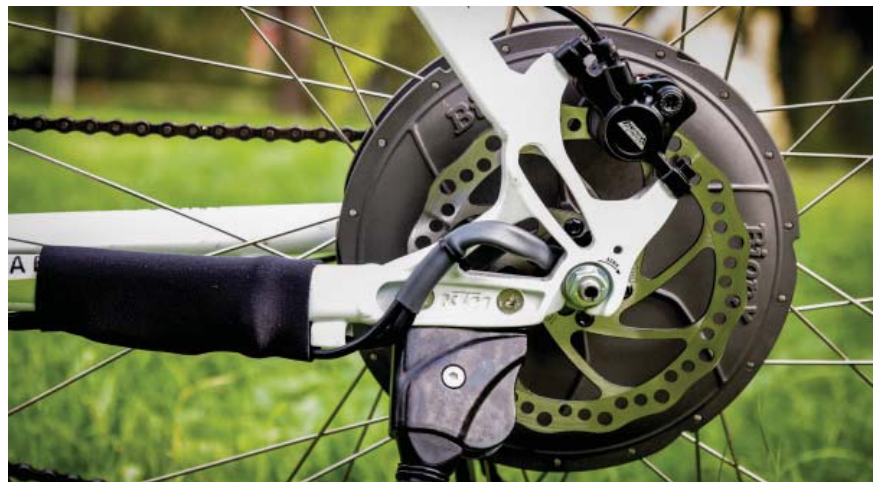
Obr. 19 Elektromotor elektrického bicykla ako súčasť náboja kolesa 23
