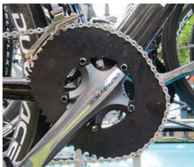
Obr. 10 Asymetrické predné ozubené koleso prevodníka na bicykli 14
